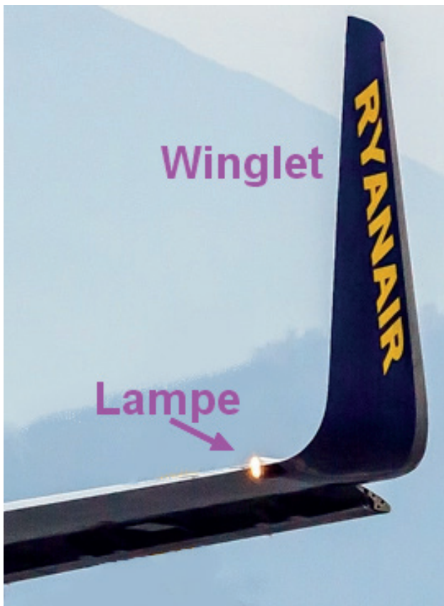
Winglet mit Lampe an einer Boeing 737-8AS, die selbst bei Tageslicht sehr hell erscheint. Quelle: www.jetphotos.com/photo/8522355
